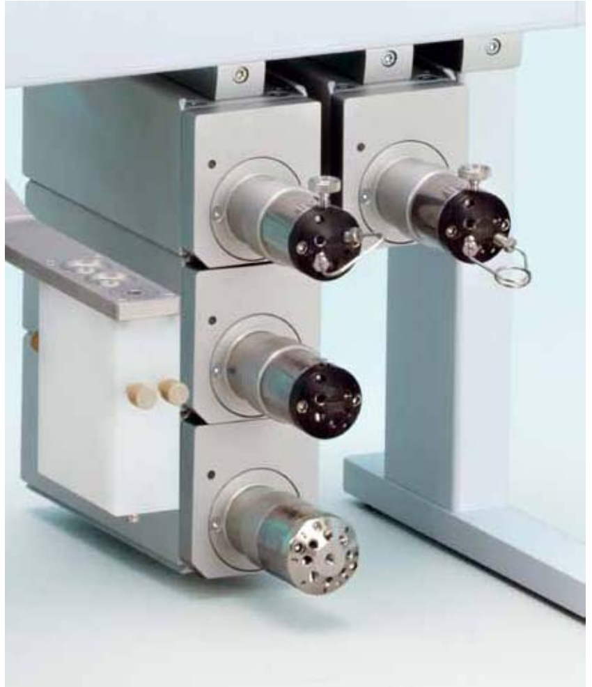
3 个进样阀和 1 个选择阀。错列的进样口配置减少对 x 轴空间的需求
