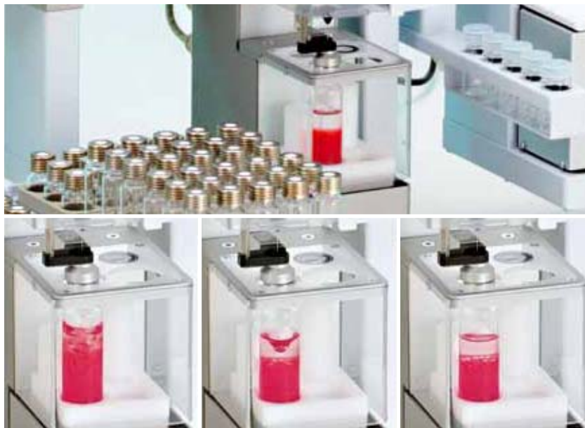
蜗旋混合器展示全自动液液萃取过程
