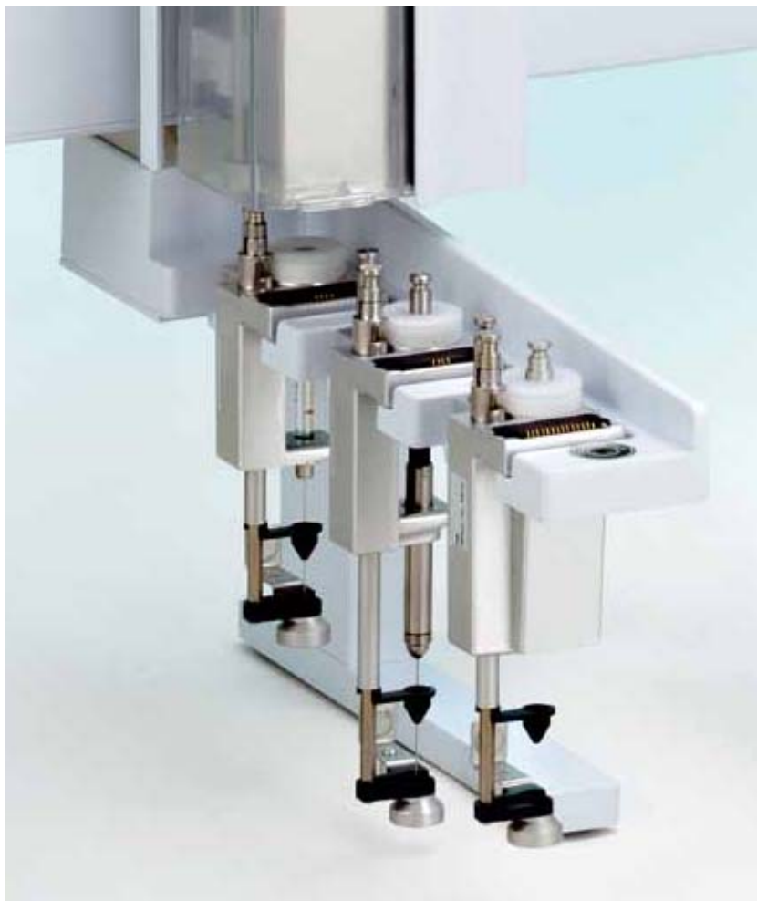
带液体进样、顶空进样和 SPME 进样工具的进样模块
