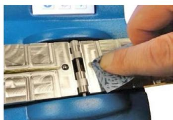
SpectroVisc Q3000可以直接快速、准确测定油液在40°C下的运动粘度，使用户可及时识别出由于油液老化、外界污染或混油污染所引起的粘度变化，有效提高设备的可靠性、避免设备不定期停机。用户可以定义被测油液的粘度系数，根据测得的40°C下的运动粘度自动计算油液在100°C下的运动粘度。同时，Q3000支持多点校正功能，用户可根据其检测需求，对特定的粘度范围进行校正，有效提高了仪器的检测精度。
