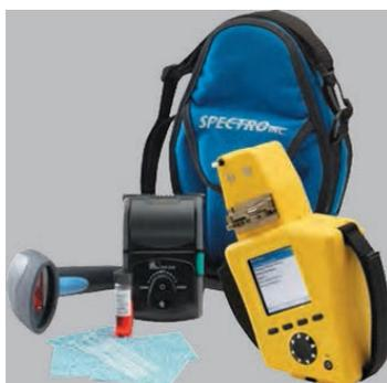
Fluidscan®-Q1000型便携式油液状态分析仪，基于直读红外光谱(DIR)专利技术，用来直接定量分析润滑油液的各种关键状态指标，直接测定合成油或矿物质油的老化程度以及污染程度。直接定量检测结果包括：总酸值TAN、总碱值TBN、氧化度、硝化度、硫化度、添加剂损耗、混油污染、微水、烟炱、乙二醇（冷却液污染）、油液匹配度以及生物柴油中的脂肪酸甲酯(FAME)等。
