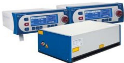
主振荡器功率放大器 MOPA 激光系统，638nm..1180nm，可达 3000mW，专利技术，内腔采用模块化设计，方便的激光二极管更换，窄线宽，mode-hop 自由调节可达 30GHz，空间光或者光纤耦合输出可选。
