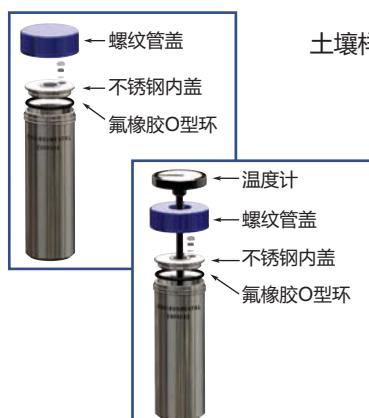
土壤样品萃取管，不锈钢主体材质，配套螺纹管盖、不锈钢内盖、氟橡胶O型环等
