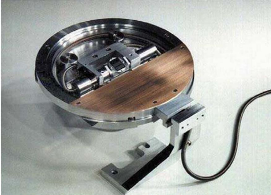
在这张照片中所示的特殊的旋转倾斜样品台可用于许多实验。这个模块被特别设计成一个可以附加到已有样品台的旋转和倾斜模块。它可以插入到样品台上。直流电机用于驱动旋转和倾斜动作。
