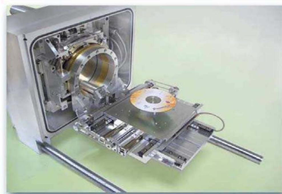
这一系列样品台针对特别大的样品，如晶圆片而设计的。它也非常适合于承载样品台。可适用于大部分的扫描电子显微镜。大致结构就是直角坐标和可倾斜的共心样品台设计。在大多数情况下，样品室内部的大小（包括一些检测器等），影响决定可放入的晶圆片大小。
