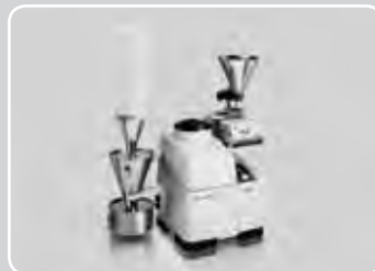
使用超离心研磨仪研磨
