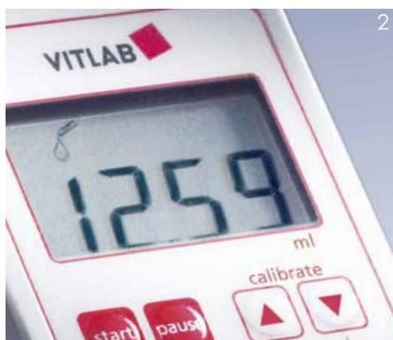
少量和微量液体体积的化学容量分析通常需要大的浓度。VITLAB® continuous 连续数字滴定器 (图1) 使连续滴定成为可能, 并提供快速, 方便和精确的结果。角度显示功能可清楚简便的读出4位滴定体积数据 (图2), 简化了操作。旋转两只手轮使滴定介质通过专利认证(EP 801 982)的双活塞泵 (图3), 在一个无脉冲的方式进行连续滴定。无需进行填充操作。技术革新提高了安全性。紧凑的构造和低重心设计可避免其翻转, 特别是用于小瓶子时。放液管的高度和长度可调节, 使其可安全的用于各种高度的瓶子。专利认证的再循环系统 (EP 542241) 有效地减少了贵重溶剂的损失, 并避免飞溅。简单的校准功能, 使VITLAB® continuous可快速满足测试条件的改变, 零关机时间。误差范围在 DIN EN ISO 8655-3的范围内 (包括部分容积)。VITLAB® Continuous 通过 DIN 12600 认证。
