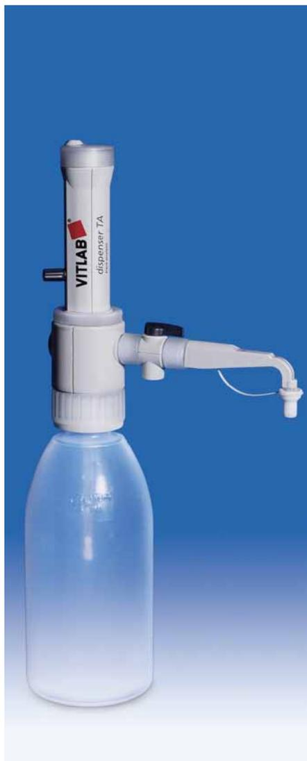
新型分配器 VITLAB® TA 是可以满足痕量分析中最严格的纯度要求的分配仪器。特殊的清洗步骤，痕量分析前的实际应用验证，使其可满足严苛的无污染的操作条件。与媒介接触的部分使用的原材料为多种氟塑料 (例如 ETFE, FEP, PFA, PTFE),  $Al_2O_3$ -蓝宝石, 铂铱或钽 (取决于型号)。痕量金属含量的释放被控制在低于ppb级, 根据不同的应用, 也可控制在ppt 范围。可更换阀门弹簧: 根据不同的应用, 有铂铱或钽阀弹簧可供选择
