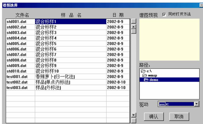
然后在此选择相应的谱图文件，则该序号点的文件前出现一个“+”号。各个点定义完成后，单击“重读峰文件”即可显示出校正曲线。
