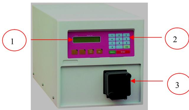
图 9 紫外检测器前面板和流通池
