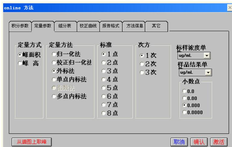
设置好“定量方式”、“定量方法（外标法）”、“标准（8 个浓度标样，选‘8 点’）”、“次方”、“标样浓度单位”、“样品结果单位”。
