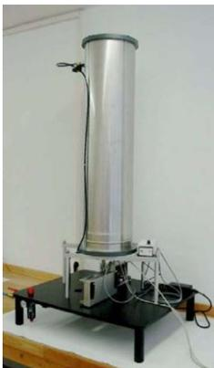
使用标准颗粒物和标准颗粒物发生器（GRIMM自动校准塔）对被校准仪器进行校准。
