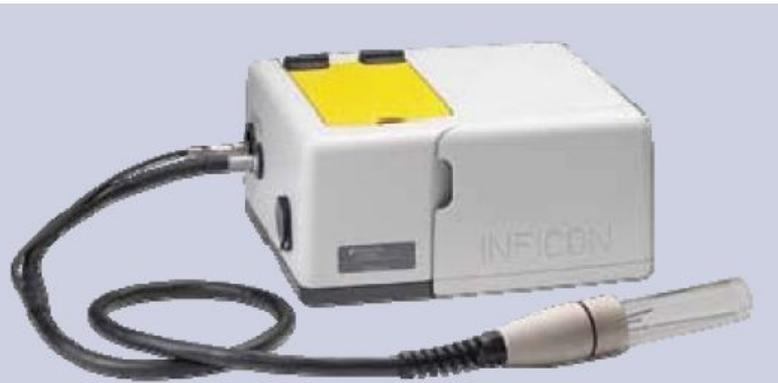
HAPSITE SituProbe —通过改进的冲净和捕集系统, 用于实验室质量的水分析. 用它分析连续水流中的各个样品, 检测上限进入 PPT 量级.
