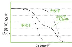
自相关函数的测量是通过对比时间t与t+tau时散射光的强度来实现的。在极短的时间间隔里，粒子的运动很微小因此散射光强度的变化也很小，所以自相关函数的值很大（接近于1）。如果延迟时间很长，粒子的运动相对显著，自相关函数的值也相对较小。此函数值与散射光强度的时间平均值有关。自相关函数值的变化速度对应于粒子的运动速度，因此也对应于与粒子的大小。测量得到的自相关函数通常呈指数级的减小，体系的扩散系数可以通过下式求得：
