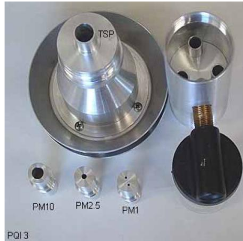
miniPM 带所有喷射气流孔的内视图
