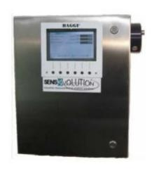
HygroP 被集中式基本控制单元 (BCU) 补充。BCU 控制和处理 从多达六个探头生成的原始数据,显示并传递浓度指数到客 户指定单元。它也可以收集来自第三方的仪器数据,并使用 它们进行计算。该仪器能生成趋势报告(配置周期和平均数) 和校准状态报告(零点和校准报告)。数据被归档到 140GB 存 储器(OPC 和 0DBC 准备)。
