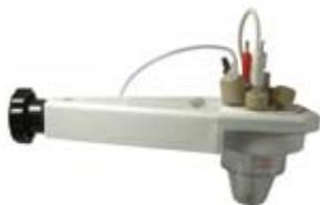
对于微量样品的分析电化学，K0264微池是个极佳的选择，溶液体积仅需200mL。此附件包含一个玻璃的池体，顶部为环形支架可用来放置多种微型电极，Ag/AgCl参比电极，铂金对电极，以及参比电极的添加液，气体吹扫管件各类连接附件等。顶板与池体之间通过特殊累级密封连接，且顶板各孔与电极及附件连接件之间均有密封圈，以避免研究体系受到大气影响。
