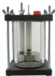
此涂层评价池是用于平整样品的涂层和腐蚀研究。当被研究的电解液不能使用标准参比电极，多使用此附件。通常被研究的样品直径和面积分别为6.35cm 和32cm<sup>2</sup>。
