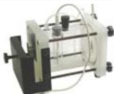
从实际经验中产生的平板池设计，简单易行地用于腐蚀和涂层研究。在它上面使用的样品尺寸可以非常宽泛，完全无需机械加工或特殊处理。快速简易地安装和拆卸样品，整个样品池约250ml，测量面积为1平方厘米。
