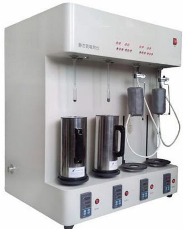
外气室同进气、抽气管路系统完全隔离，大大提高了仪器的保压性能，实现了最佳的控制系统；
