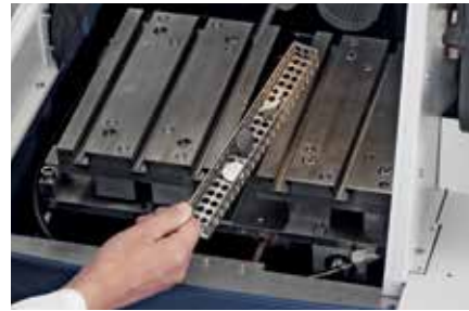
利用零件收集托盘可以快速找到切割后的样品
