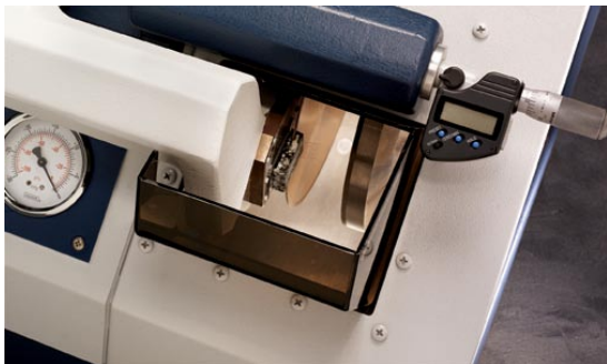
玻璃载片镶嵌的样品在金刚石切割刀片上切片。砂轮(右)在不移动样品的条件下减小样品的厚度
