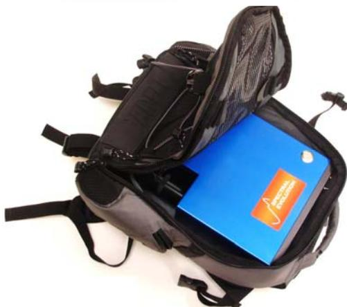
SPECTRAL EVOLUTION公司SR系列便携式波谱仪配备锂离子充电电池，整机重量约3.6公斤，适用于野外操作。仪器可选配前置光学系统（4、8或14°视场）或可替换光纤，手枪式光纤手柄或者积分球采集系统（可选配件）。SR系列便携式波谱仪还可以选购野外背包或者有/无滚轮的运输箱。SR系列便携式波谱仪均配备USB和无线蓝牙。为野外操作方便，我们还提供Getac PS236型掌上机，该机提供480x640点阵VGA显示屏，内置SiRFstar III GPS地图仪和3百万像素数字照相机、电子指南针、海拔高度计和专业的DARWin CE Mobile-compatible软件。该掌上机可以通过无线蓝牙对仪器进行遥控和显示。
