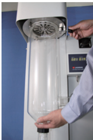
喷雾干燥塔的简便安装图 cylinder installing
