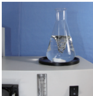
磁力搅拌器 Magnetic Stirrer
