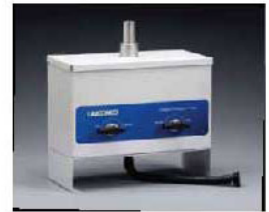
7394800 液氮制冷过滤阱, 连接真空干燥室与真空泵之 间, 防止气态污染物进入真 空泵。最低温度可达-196℃
