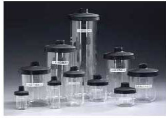
快速冷冻瓶, 由耐高温、高压的 硼硅玻璃瓶身和硅橡胶盖组成, 瓶壁具有最大热均一性.使冻干 样品快速冻干,装样量不超过1/3, 样品均匀冻结在瓶壁上,使冻干 表面积最大,达到最大的冻干高 效.有多种型号可选.
