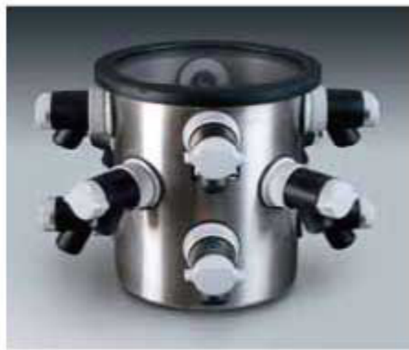
7522800 12头不锈钢干燥室， 尺寸：24.8cm×20.3cm， 重量：5kg
