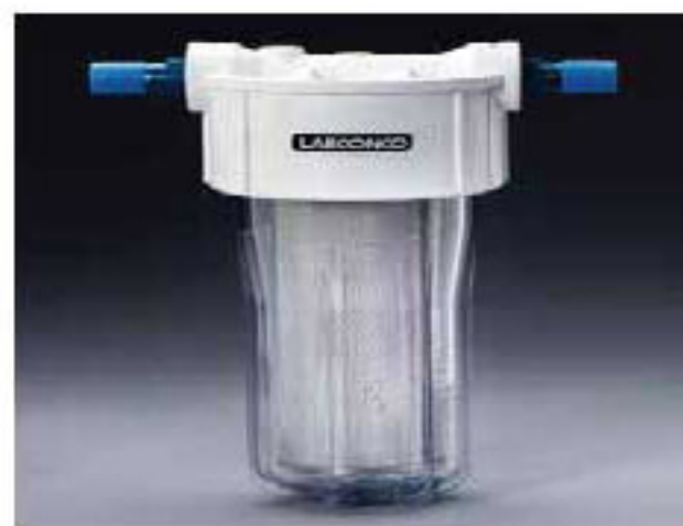
7772000 腐蚀性化学物质过滤 器, 可过滤腐蚀性化学物质, 保护真空泵不被污染, 滤网由 白色变为蓝色后需更换。
