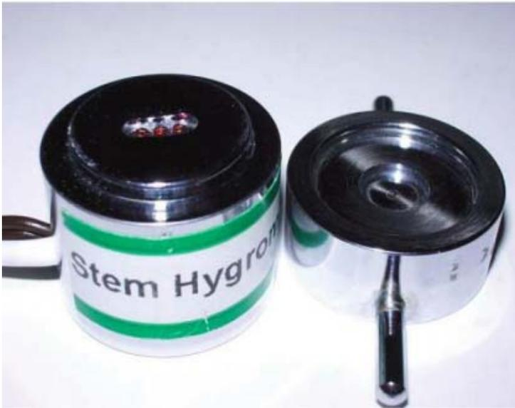
PSY -1 由包含两个安装在表面镀铬的黄铜底座上的镍铬-铜镍合金组成的热电偶(E 型热电偶)构成的测量室。其中一个热电偶用来测量茎秆，另一个同时测量测量室中的空气温度，内部通过半导体制冷以控制温度并测量干湿球温差。
