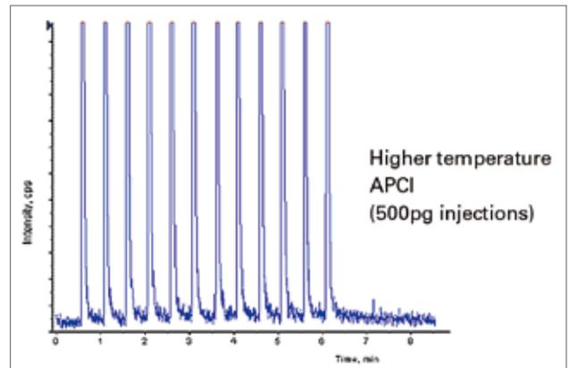
Turbo V™离子源消除交叉污染。即使进样体积很大，每30秒进样一次5-氟尿嘧啶，没有发现峰拖尾
