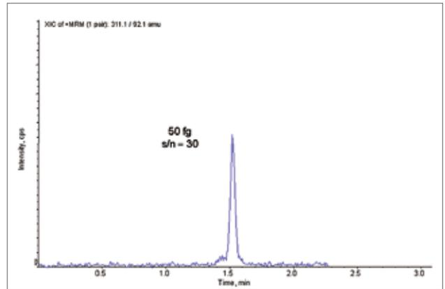
ESI电离模式下，在3 mL/min流速下，不用分流，显著提高灵敏度
