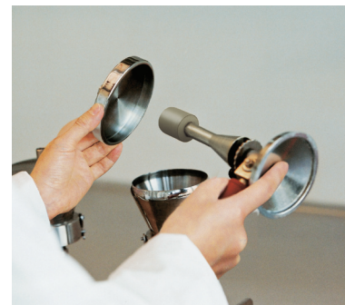
6. 灼烧漏斗内侧和漏斗盖
