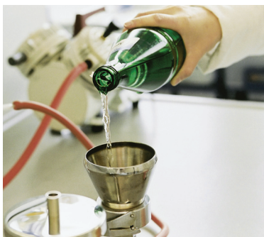
10. 过滤样品，然后用无菌水或生理盐水冲洗漏斗内侧
