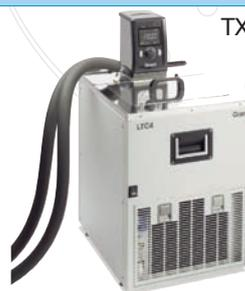
TX150+R4可编程制冷循环浴套装, 并提供导管和夹具, 即插即用
