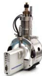
**可选配置：PhotoSpray™电离源** 大气压光电离技术（APPI），大大拓展了可分析的化合物范围。PhotoSpray®电离源可以使多种不易被ESI或APCI电离的化合物（例如低极性的多环芳烃（PAH））有效离子化。
