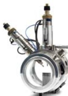
**可选配置：DuoSpray™电离源** 在同一离子源基座上包含了可容纳TurbolonSpray®和APCI探针两套装置，通过计算机控制进行切换，您可以在单次LC进样中针对每个化合物优化离子源条件，是快速方法建立的理想工具，同时提升了分析通量和数据质量。
