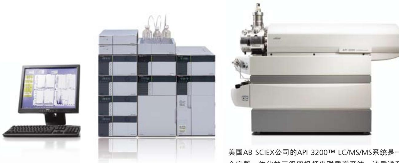
美国AB SCIEX公司的API 3200™ LC/MS/MS系统是一个完整一体化的三级四极杆串联质谱系统，该质谱系统设计紧凑、功能齐全，可提供优异的灵敏度和选择性，并最大限度地延长正常运行时间。
