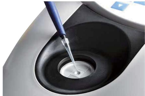
图2.内置样品室可直接上样体积为1到5 $\mu$ L的样本。
