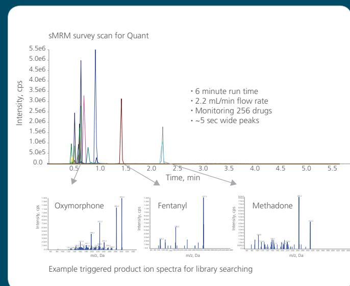
QTRAP 4500质谱系统可以采用Scheduled MRM™ (sMRM) 触发高质量的全扫描子离子扫描，并用于库检索。相比三重四极杆全扫描模式，线性离子阱扫描模式具有更高灵敏度，可检测和鉴定浓度为1/100的化合物。
