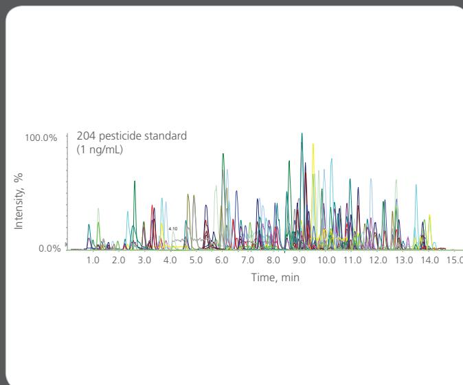
凭借业界最短的离子驻留时间，4500系列质谱成为多组分污染物分析的理想工具。上图显示了4500质谱系统检测超过200种1ng/mL水平的农药。更快的电子学和智能化Scheduled MRM (sMRM)，在一个UHPLC运行时间内可筛查上千种杀虫剂。
