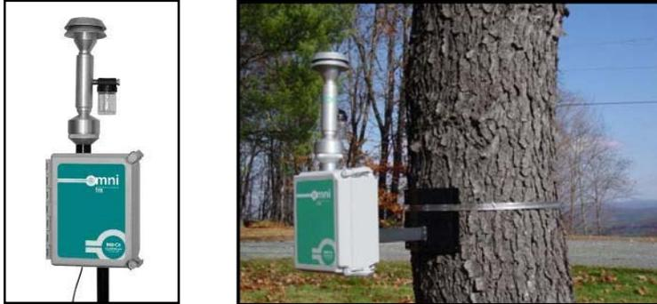
为减低成本并保持仪器的均衡重量，当在采样达到低流速的饱和状态时，BGI 公司最新使用了一个精确的5 LPM 采样头，使frmOMNI 采样器处在该领域的最领先地位。美国EPA 鼓励美国州一级和地方的空气监测部门使用非参比方法的小型便携式采样器，做多点的短期污染监测研究。
