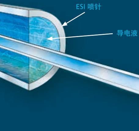
CESI 8000 系统将低流速的毛细管电泳分离通道和电喷雾离子化喷针有机的整合于同一根毛细管中，无需采用任何形式接口，不产生任何死体积。
