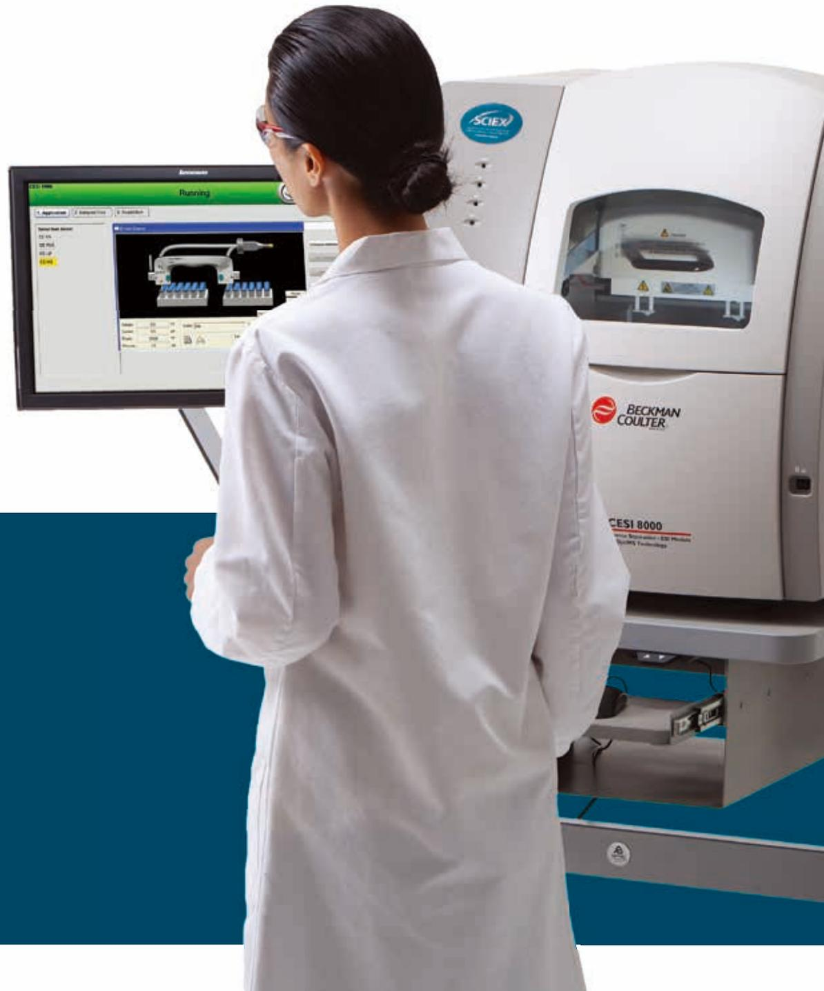
CESI-MS 是毛细管电泳和质谱连用的理想方式。基于 Mann 教授和 Karas 教授的理论，CESI-MS 通过采用超低流速的分离和离子化技术达到增加灵敏度、降低离子抑制效应的目的。
