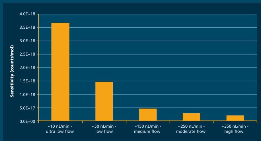
样品: 2ng/mL 血管紧张素 I 的 10% 乙酸溶液。ESI 电压, 1350V, 检测范围, 50-3000 m/z。
