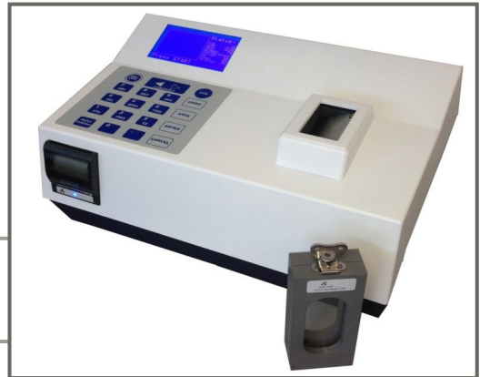
MultiScan Series 1000 酒精, 脂肪和 水分分析仪
