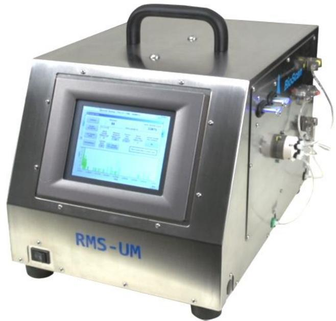
**Real-Time Monitoring System – Unity Model** 是一款不依赖于培养基生长的无损实时微生物和粒子分析仪，用于各种水质检测。RMS-UM具有批式取样分析或直接在线分析的灵活性。
