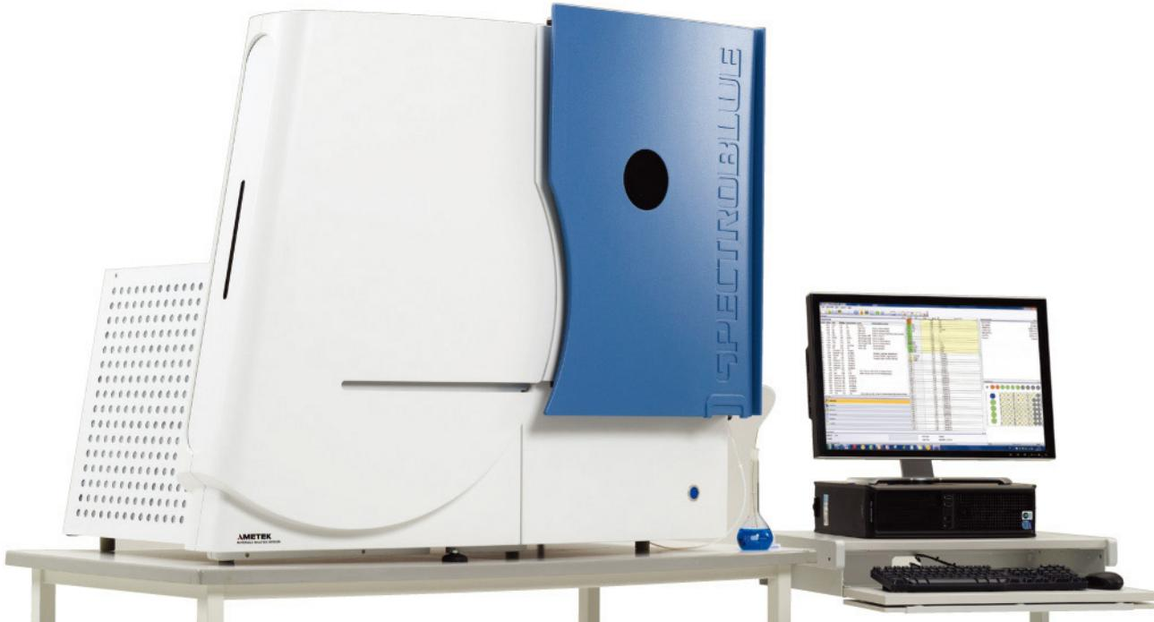
德国斯派克分析仪器公司最新推出了一款结构紧凑、光谱范围通用的ICP - OES光谱仪——**SPECTROBLUE**。该仪器集斯派克公司在电感耦合等离子体发射光谱仪领域近30年的精湛工艺与科技成果之大成，极大地提高通用实验室承担分析任务的能力。**SPECTROBLUE**采用750mm焦距的帕邢-龙格光学系统与15个线性CCD阵列检测器，使其具有无与伦比的光学分辨率和灵敏度。此外，**SPECTROBLUE**还创新性的使用UV - PLUS气体净化技术，以解决光学系统的净化问题；并采用突破性的OPI - AIR接口，免除了昂贵复杂的外部水冷系统。**SPECTROBLUE**选用最稳定可靠的RF发生器，以获得最佳的分析性能。该仪器采用极其可靠的设计和非凡的技术，性能卓越。不仅操作和维护非常简便，而且性能价格比极高。
