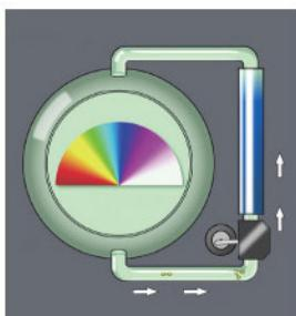
SPECTROBLUE的卓越性能令人惊憾。它还配备了斯派克公司的UV - PLUS气体净化系统。在密闭充氩的光学室内，用小型隔膜泵使氩气通过净化管净化循环，确保系统的长期稳定性和100%的利用率，它无需任何额外的高纯气体消耗。
