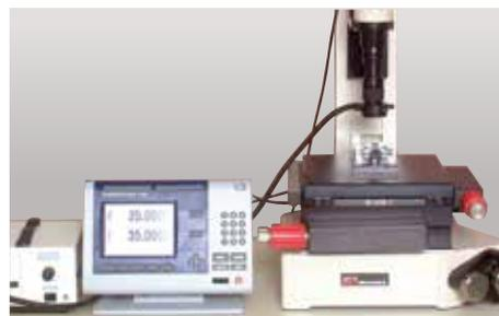
图12 高倍的光学影像定位系统，使高倍定位更加准确
