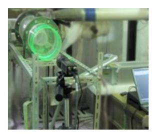
粒子图像测速(PIV)是在教育和研究中使用流程可视化的光学方法。它被用于测量瞬时速度以及和流体有关的属性。液体通过用激光来照射示踪粒子(比如空气中的烟雾,与水密度相同的小型空心颗粒)使其可见并捕捉他们的图像。利用示踪粒子运动的连续图像来计算正在被观察的流体的速度和方向,进一步处理可以标示旋涡,流线,等速度线和流场参数分布。MicroVec PIV系统的标准配置包括一个数字CCD或CMOS相机,配有光学装置的激光,同步器,示踪粒子和所研究的场,一个用来连接激光到透镜设置的激光手臂,将光束转化为光片,PIV软件用来处理光学图像。
