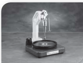
样品水平调节装置 (和中心力卡具使用)
