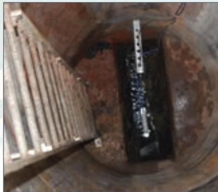
使用 SPEEDY 和 dBS6 在水渠内X面积速度测流法
