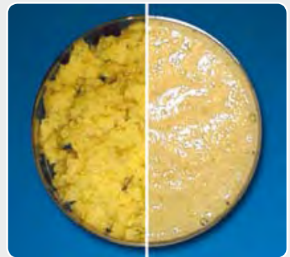
上图显示了使用家用混合搅拌机（左）与使用GM200（右）对生土豆进行粉碎所得的粉粒度比较
