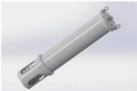
PLOC-100是一种能对管网内水量水质信息进行原位连续监测的多指标在线监测设备。集成了ORP、pH、电导、温度、液位等传感器，包含供电单元、控制和数据采集单元、远程无线传输单元，通过特殊的结构设计，经精密加工而成。该传感器可以方便安装在空间狭小的排水管道或窨井内，维护简单方便。且能适应于具有较多沉积杂物和较强腐蚀性的污水环境，抗干扰能力能力强。
