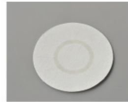
将样品滴在滤纸上干燥后进行检测分析
