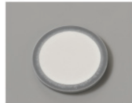
用压片机加压成形（压力成型法）
