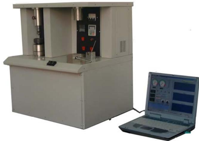
XF-2266 自动四球法润滑剂抗磨-极压性能试验仪是本公司最新开发出来的高科技产品。仪器适用于测定润滑油/润滑脂的抗磨性能和极压性能。仪器采用了高科技复式变频检测换算系统，可自动检测磨痕、PB(最大无卡咬负荷)、ZMZ(综合磨损指数)、PD(烧结试验)等测定项目。无论是外观造型或自动化程度均处于国际领先水平。
