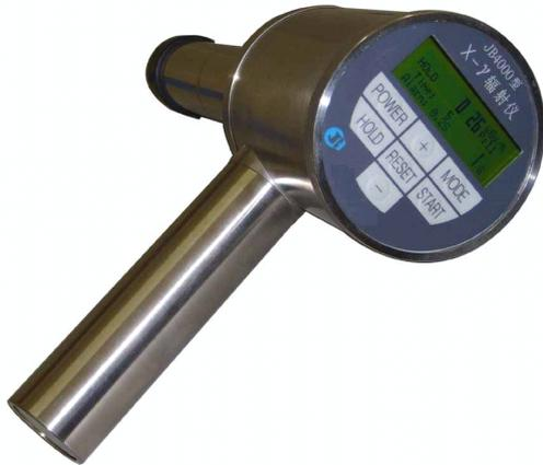
JB4000型智能化x- $\gamma$ 辐射仪是监测各种放射性工作场所x、 $\gamma$ 射线辐射剂量率的专用仪器。和国内同类仪器相比，该仪器具有更大的剂量率测量范围和能量响应特性。
