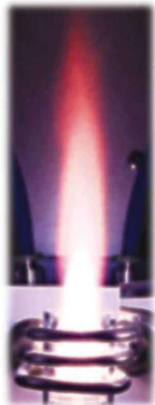
ULTIMA 2 具有同时可观测 ICP 整个正常分析区 (NAZ) 的优点。这是由于采用 110X110mm 大面积光栅和相当于 NAZ 尺寸的高效传光组件。由于可同时观测整个 NAZ，因此可在相同条件下获得对所有元素都最佳的检测结果。无需用多元素折衷条件，提高了生产效率。
