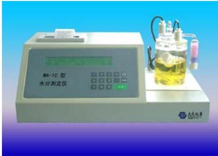
WA-1C 型水分测定仪应用经典的卡尔·费休测水原理及库仑滴定原理，结合计算机技术研制而成。根据法拉第定律，通过测量分析过程中电生碘所消耗的电量，采用单片微型计算机进行数据处理，计算出样品中水的绝对含量和相对含量。
