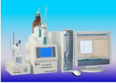
仪器由 PC 机控制，参照 SH/T 0162 采用电位滴定法，自动求出样品中碱性氮的含量。仪器对电极电位进行动态平衡采集、对滴定曲线进行平滑处理、终点位置修正，保证了结果的准确性。采用进口精密型滴定单元，耐各种强酸(如高氯酸)强碱腐蚀，配置防渗透滴定头，整机寿命更长。仪器适用于石化行业各种深色及浅色油碱性氮的测定。
