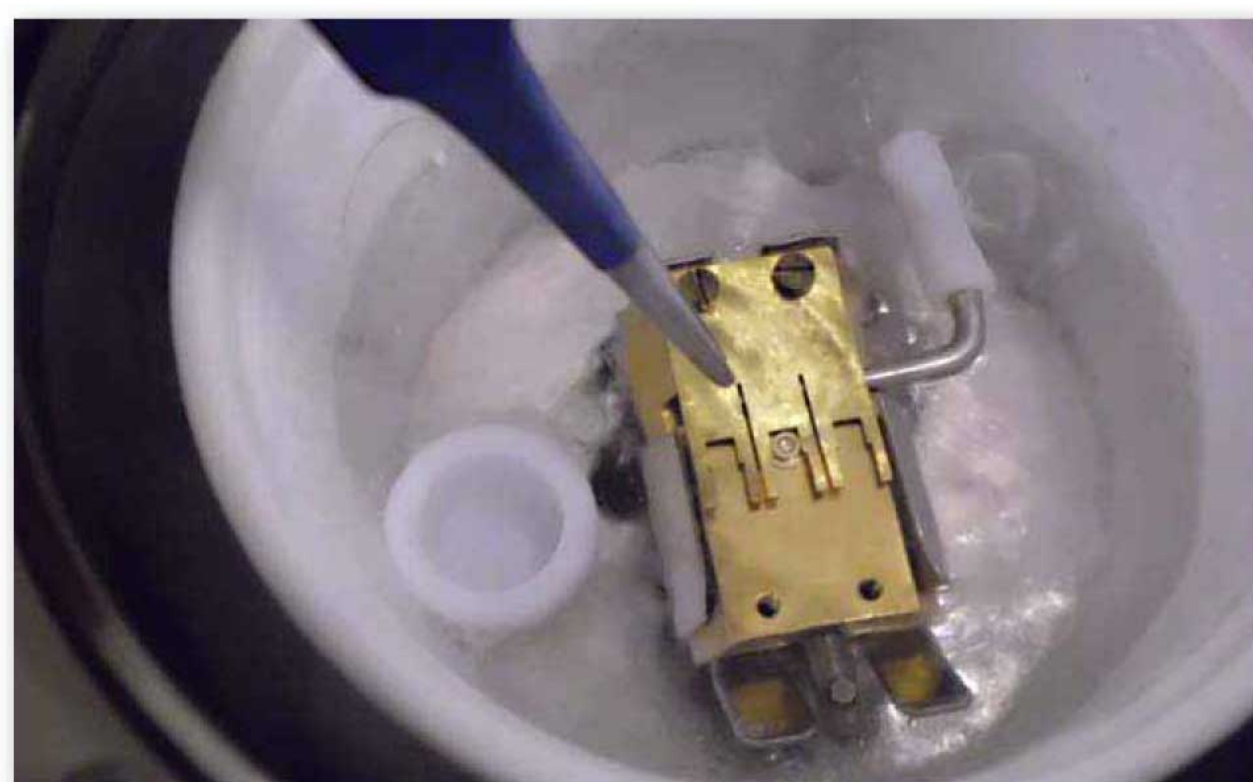
样品被转移到ALTO 样品载台上，再置入ALTO 冷冻工作站的铰链式装载工具上。
