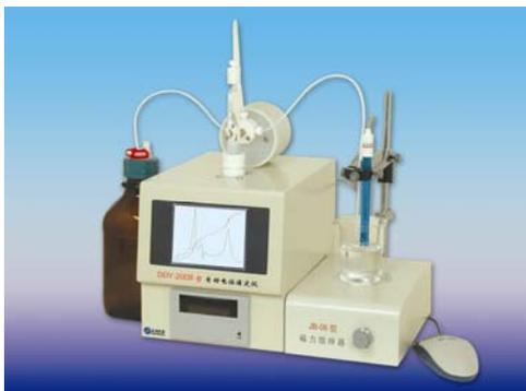
DDY-2008 型自动电位滴定仪采用机电一体化结构设计，仪器完全由微电脑(MCU 微处理器)控制，实现滴定过程及数据处理自动化、可视化。选用不同的电极可进行：酸碱中和滴定、沉淀滴定、氧化还原滴定、络合滴定、非水滴定（如测定石化油品中的硫醇硫、酸值/碱值）等多种滴定，滴定系统采用耐腐蚀的材料加工而成，仪器使用寿命长，性价比高，软件实用，适合多行业应用，尤其适合高校实验室教学与科研。
