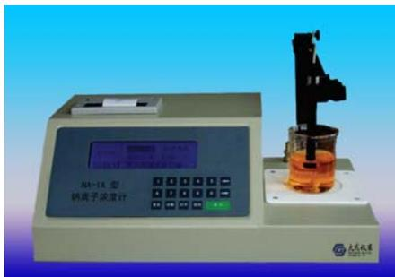
Na-1A 钠离子浓度计是一种利用直接电位法精密测量水溶液中钠离子活度或浓度、氧化还原电位和温度的电化学分析仪器。仪器根据能斯特方程，运用微计算机技术，进行人性化设计，测量过程中，大屏幕液晶显示器可实时显示各种状态信息和测量结果。
